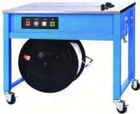
La Cercluse semi-automatique standard permet le cerclage de colis de petites au moyennes séries de production de toutes formes et volumes. Utilisation très facile, et ne nécessite que de très peu d'entretien. Faible consommation d'énergie. La bobine de feuillard est placée à l'intérieur de la machine.
